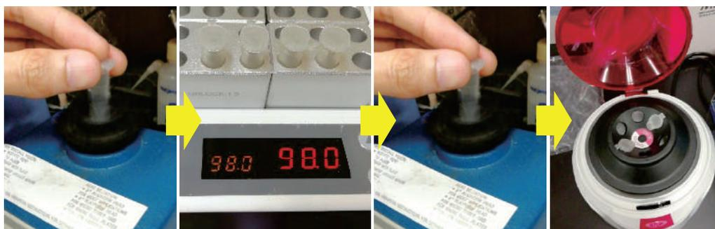
図 2-3 攪拌(10 秒)、98°Cの加熱(8 分)、再度攪拌(10 秒)、遠心分離(1 分)による DNA 抽出
