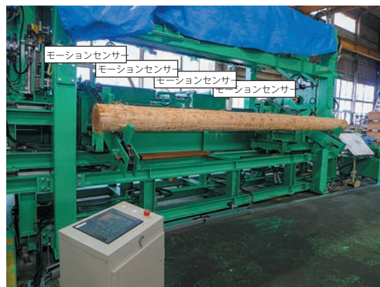
図2 試作した実大丸太用測定装置
