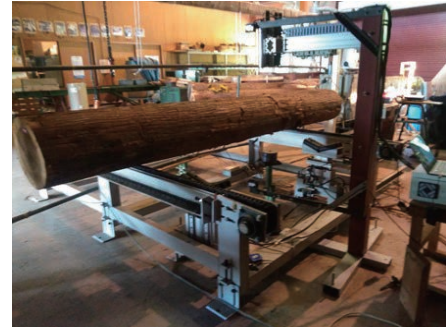
図1 低周波電磁波及びガンマ線を利用した丸太含水率推定装置
