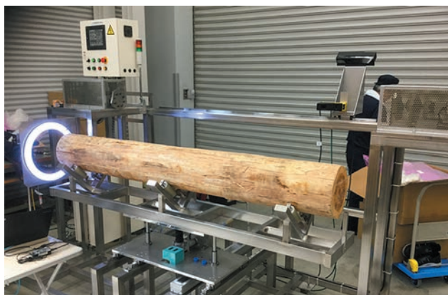
図1 試作した長さ2mの丸太用の試験機
