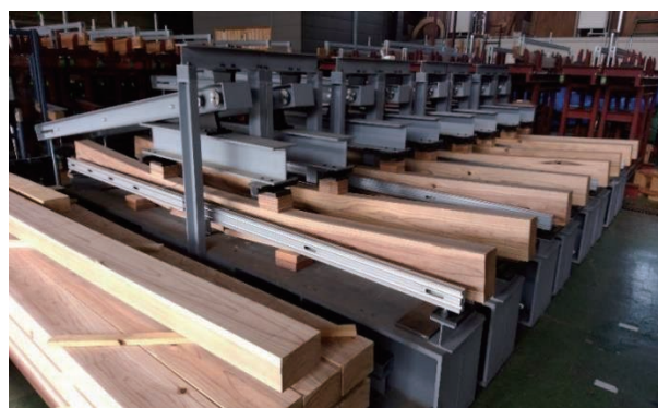
写真1 長期荷重試験の様子 (左: 温湿度一定の条件、右: 温湿度が変動する条件)
