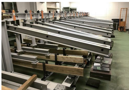
写真1 長期荷重試験の様子 (左: 温湿度一定の条件、右: 温湿度が変動する条件)
