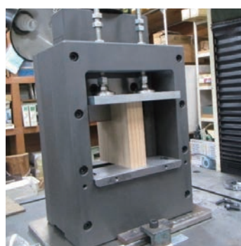
図2 スギの枠組壁工法用の製材品によるせん断試験の概要と結果 (左:試験の様子、中:試験のセットアップ状態、右:密度とせん断強度との関係)
