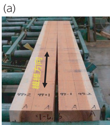
図1 製材品に生じる反りの様子 (a) と丸太内での残留応力解放ひずみの分布 (b)
