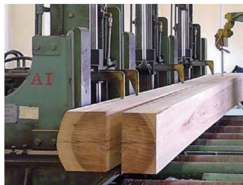
図1 送材車付き帯鋸盤による心去り平角の製材
