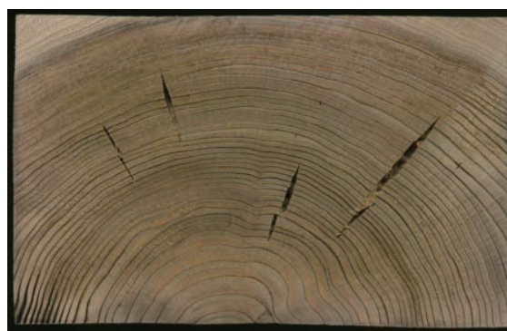
写真2 スギ心去り平角の横断面 材温が上がりすぎたことによる内部割れ
