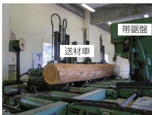
図1 送材車付き帯鋸盤による心去り平角の製材
