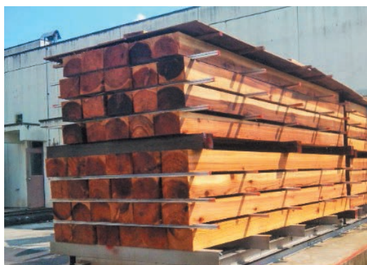
図2 乾燥処理前の心去り平角
