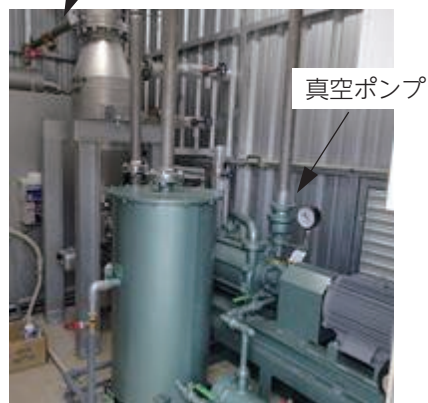
図1 熱風加熱式弱減圧乾燥機（左：本体外観、右：真空ポンプ等）
