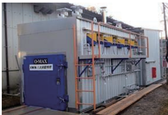
図1 熱風加熱式弱減圧乾燥機（左：本体外観、右：真空ポンプ等）
