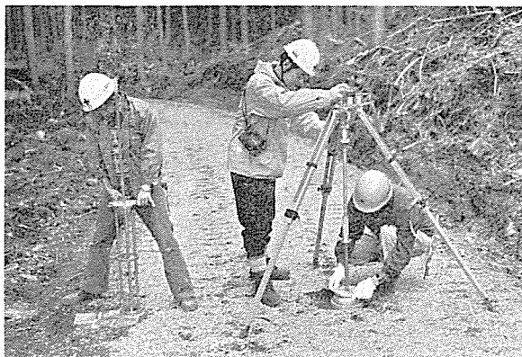
衝撃式地耐力測定器（右）と球体落下式簡易 CBR 試験器（左）
