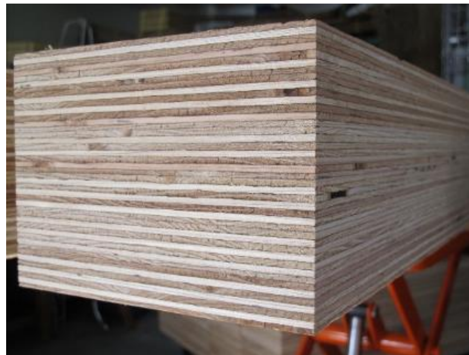
厚さ30cm以上の「超厚合板」 (従来の厚物合板の10倍以上の厚さ)
