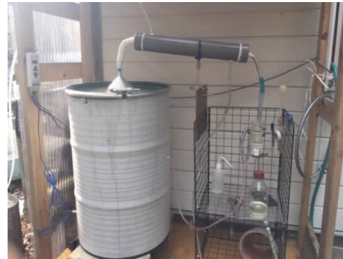
写真2 ドラム缶式精油採取装置（容量：200ℓ）
