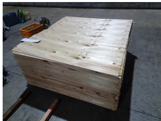
写真2 作成したコウヨウザンLVL用の単板
