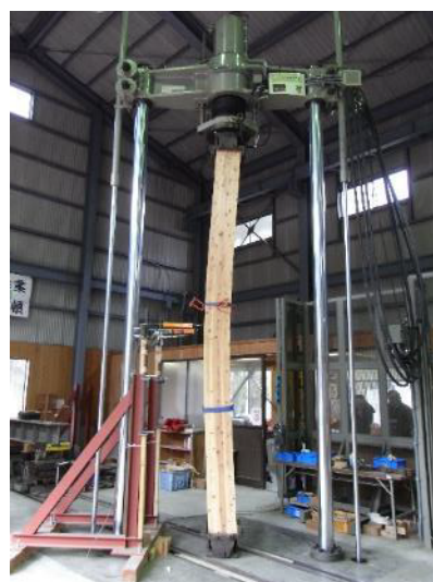
写真1 座屈試験 (90mm 柱)
