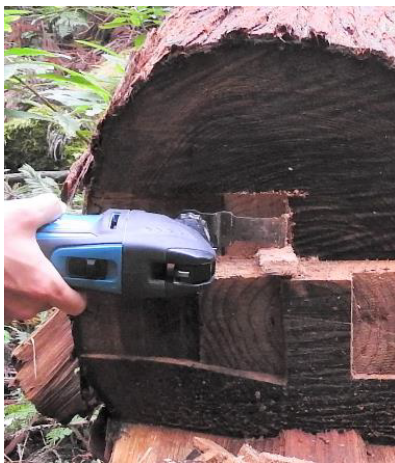
写真2 木口の切り直し状況
