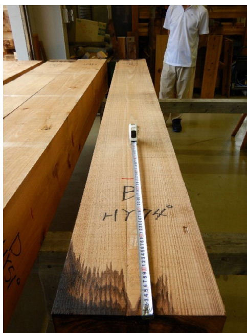
写真1 300角試験体に生じた表面割れの一例
