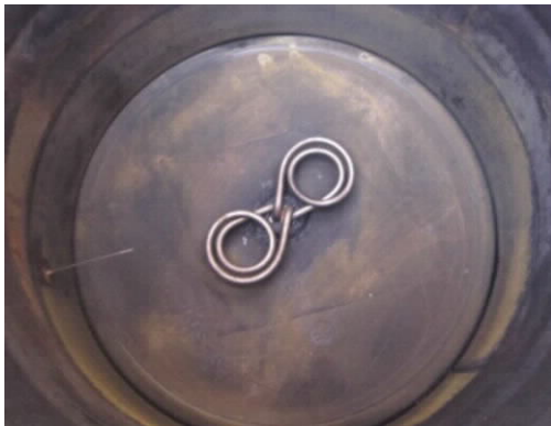
写真3 電熱ヒーター（200V、3KW）
