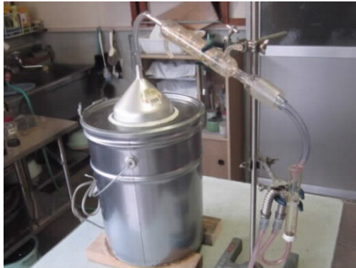
写真1 ペール缶式精油採取装置（容量：20ℓ）
