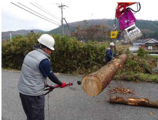
写真1 原木丸太の縦振動法の様子
