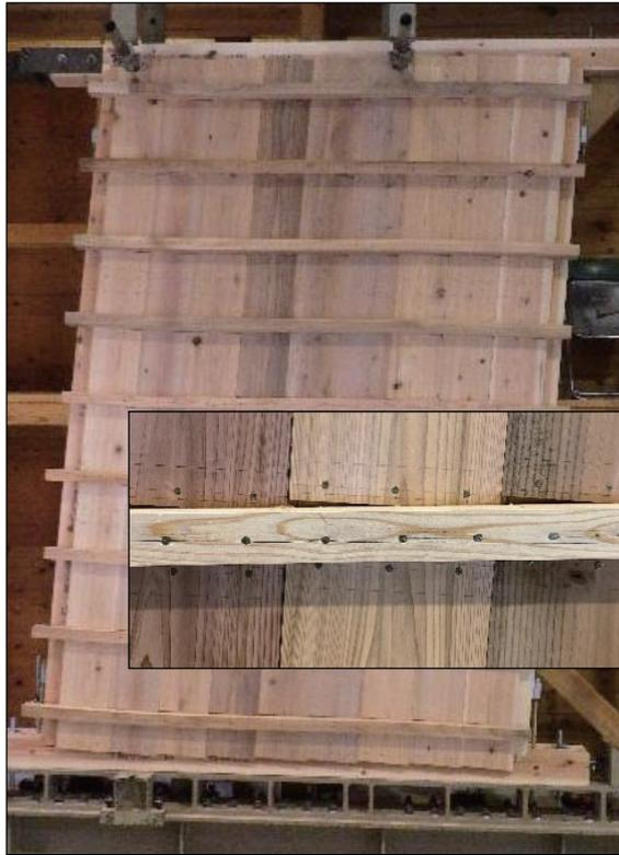
写真 1 面内せん断試験の様子
