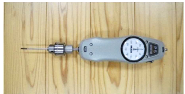
写真2 荷重計+ドライバー(軸径3mm)
