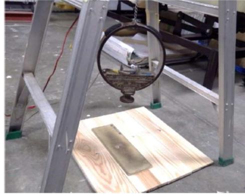
図2 衝撃吸収性能試験の様子
