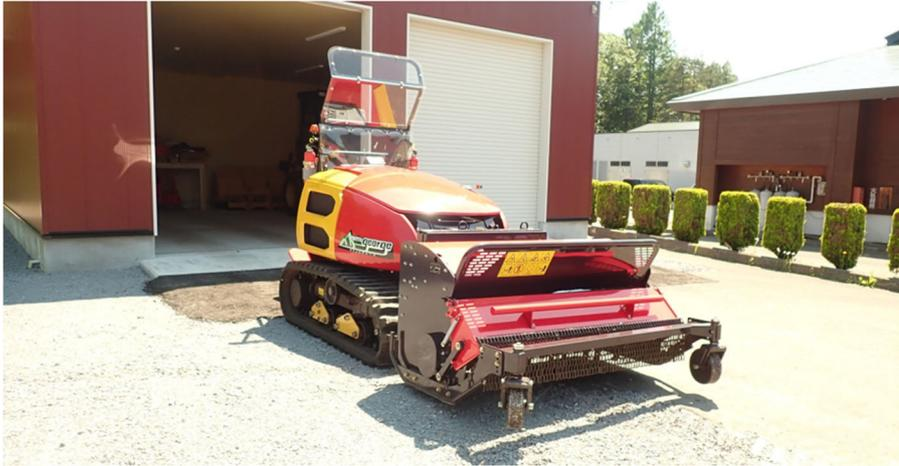
写真1 多目的造林機械の全景写真（下刈アタッチメントを装着）
