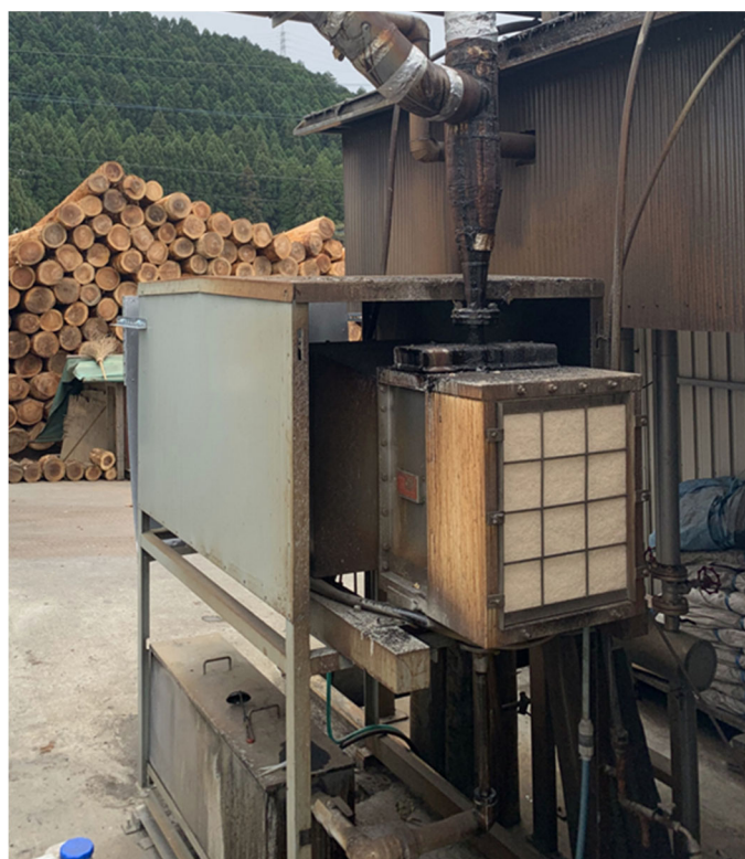
図4 ステンレス製空冷型精油回収装置外観
