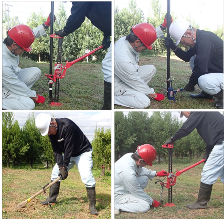
写真2 引き抜き歩掛調査(支柱:ファームジャッキ(左上)、油圧ボトルジャッキ(右上)、アンカー(引き抜き棒(左下)、ファームジャッキ(右下))
