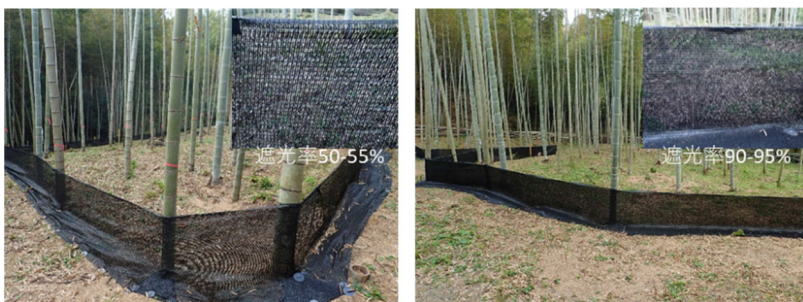
写真4 遮光ネット柵の遮光率の違いによる効果検証
