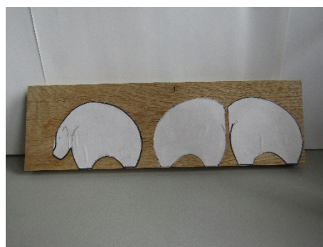
写真4 被害材心材部からの部品切出し
