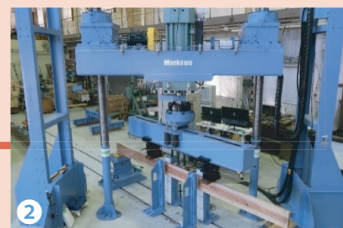
① 大径材の製材方法の検討 ② 実物大建築部材の性能評価
