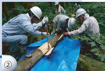
① 強風による森林気象害 (スギ林) ② 森林の放射能汚染調査 における樹皮と材の試 料採取
