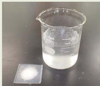
殺虫剤液剤と砂糖を水に溶かし高吸水性ポリマー（左下の粉末）に吸わせて作成した毒餌剤ハイドロジェルベイト剤。
