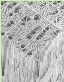
シラカバの木材の細胞壁構造
