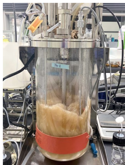
写真1 PDC生産微生物の培養槽 化学構造の異なるさまざまなリグニン分解物を代謝して、PDCを高濃度で体内に蓄積する微生物の培養に成功した。
