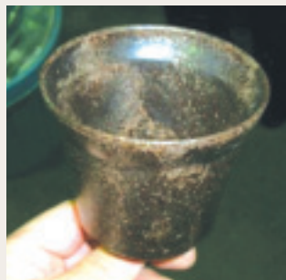
写真4 木質廃材と廃プラスチックを混ぜて作った植木ポット
