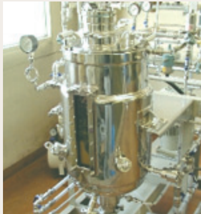
写真3 パルプからバイオエタノールを製造する実験装置
