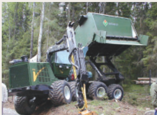
写真8 チッパー機能の付いた北欧の大きな林業機械
