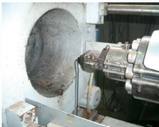
写真2 射出成型機から流れ出る木粉含有率70%の複合物 (この流動した複合物が型に射出されて鋳型の通りの製品ができます)
