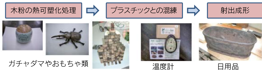
図9 木質高充填された混練型WPCからの様々な製品 (石油系プラスチックの代替へ)
