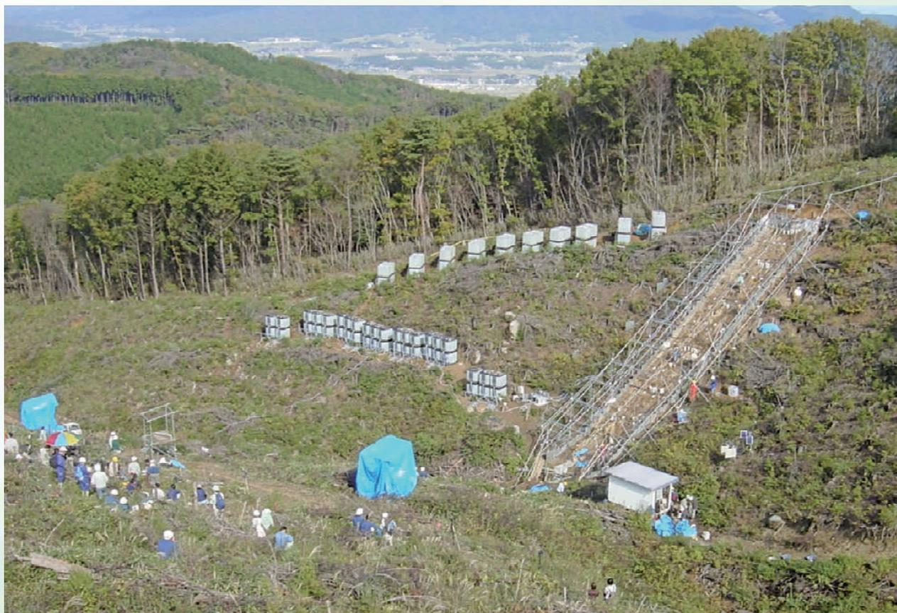
写真6 茨城県桜川市(旧大和村)の現地斜面における人工降雨崩壊実験
