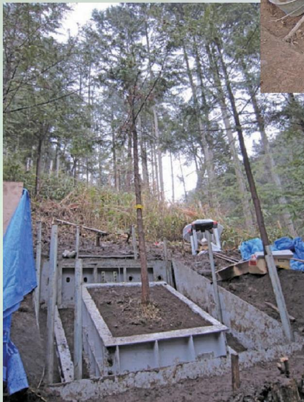
写真9 根系が土を補強する効果を測る大型せん断試験
