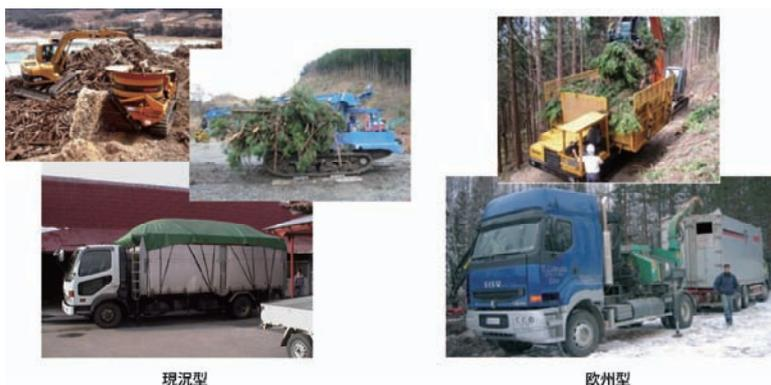
写真1 日本(現況型)と欧州(欧州型)で利用されている搬出、粉碎機械と輸送トラック。フォワーダ(右上)は森林総研にて開発。
