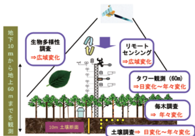
図4 森林環境観測システム 地上60mから地下10mまでの地上観測と観測衛星データを使ったリモートセンシングによる広域での長期観測を行う。
