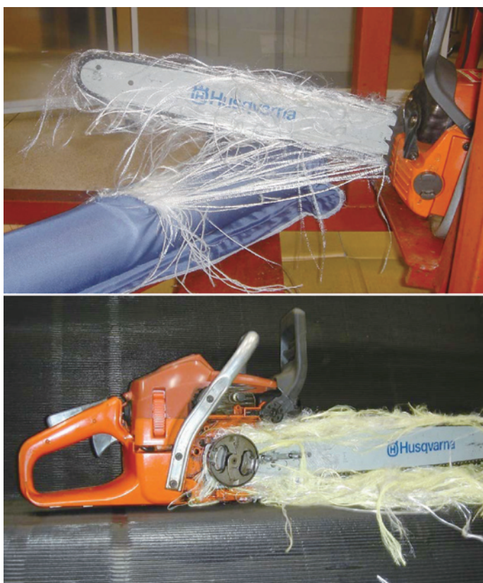
写真5 防護服内の繊維の引き出し(上)と チェーンソー内部の絡み付き(下)の例
