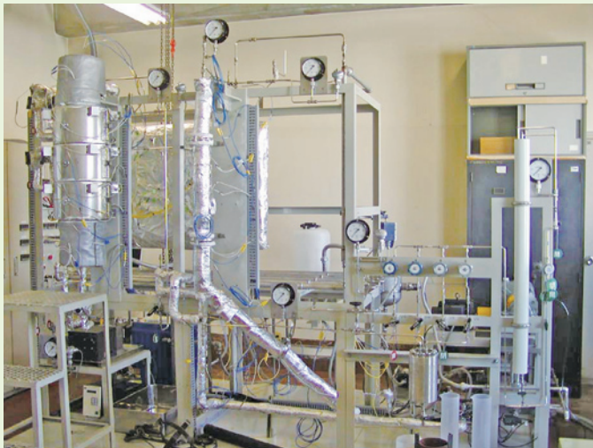
写真1 森林総研で所有している高温高压水処理ベンチプラント
