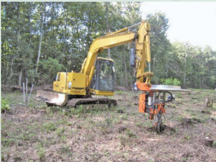
写真4 改良型コンテナ苗自動耕耘植付機
