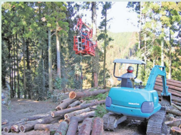
写真1 自走式搬器（自動運転試験風景）
