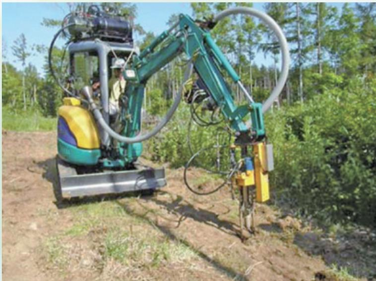
写真3 初期型コンテナ苗自動耕耘植付機
