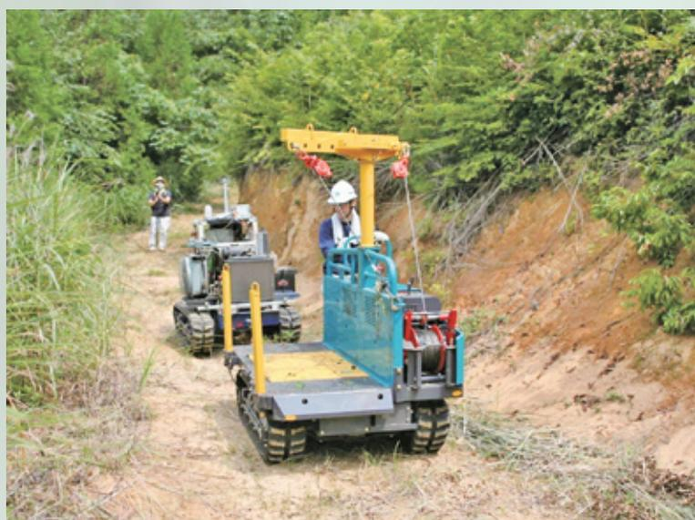
写真2 試作機による追従走行実験
