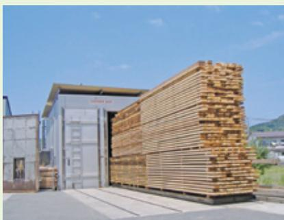
写真1 木材乾燥機に投入される製材品
