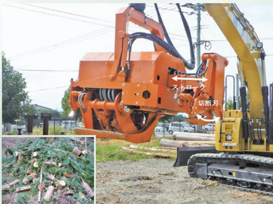
写真6 破碎機能付きプロセッサと破碎された梢端
