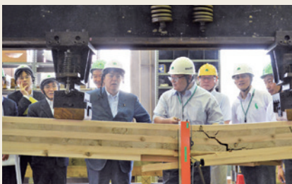
写真4 CLTの実曲げ強度試験の様子
