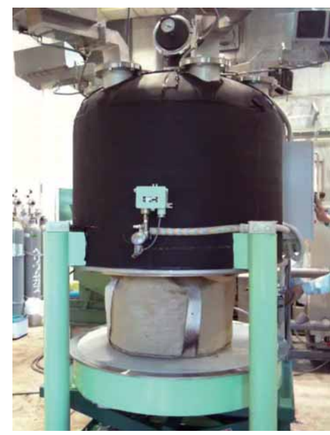
写真 2 新しく開発した減圧式マイクロ波水蒸気蒸留装置
