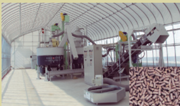
写真2 減容化プラントおよびペレット（右下、直径8mm）
