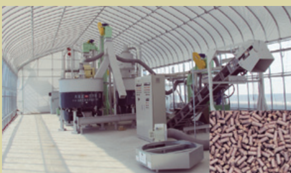
写真2 減容化プラントおよびペレット（右下、直径8mm）
