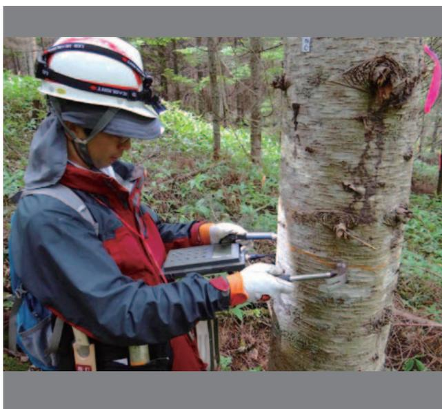
トドマツの材質非破壊試験（横打撃共振法）による選抜の効率化
