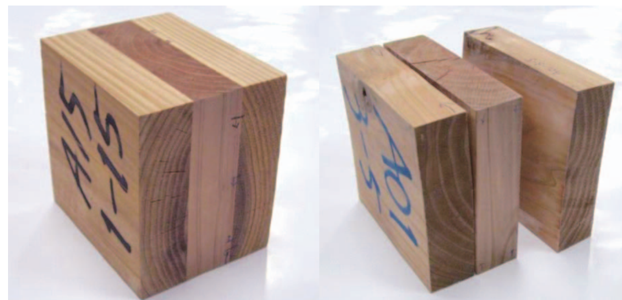
図1 接着不良検出のための剝離試験結果 左：正常例 右：接着不良例
