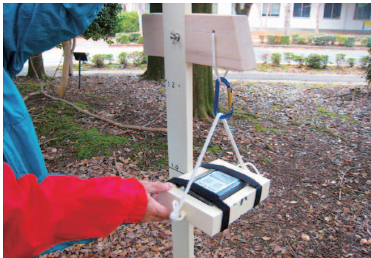
図4 上下方向別空間線量測定の測定機器と測定の様子。 小型線量率計を鉛の遮蔽台にセットし、背面と側面からの放射線を遮断し測定を行う。
