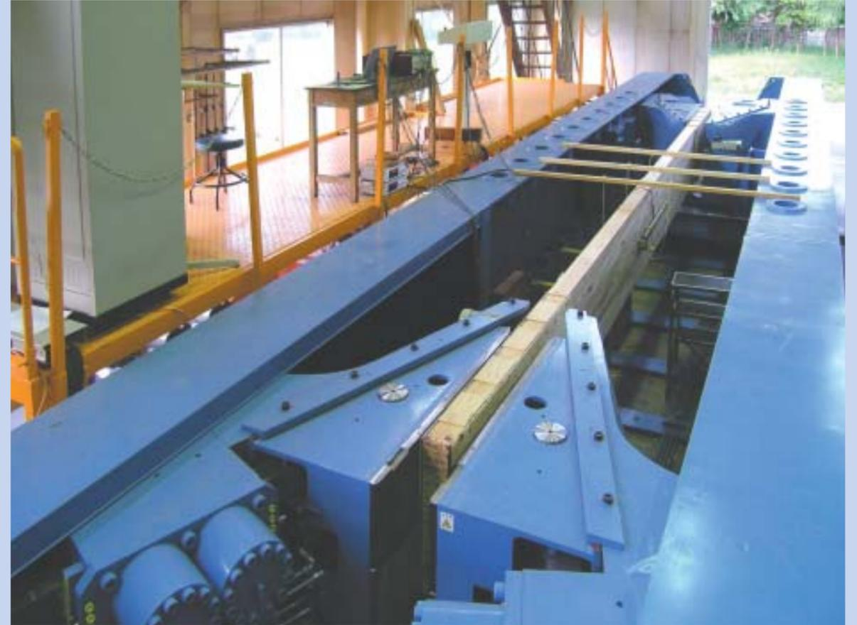
写真1 集成材(寸法:105mm×600mm×7400mm)の引張試験の様子
