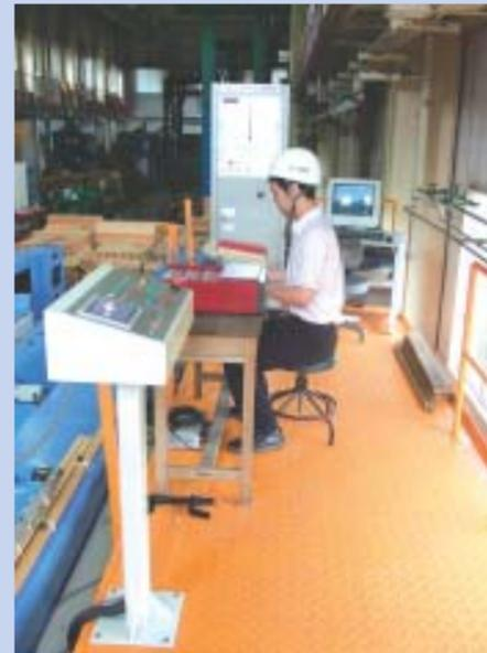
写真2 作業デッキ上に設置された計測及び自動制御ユニット
