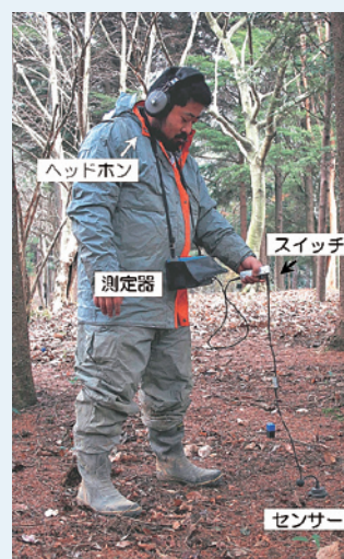
写真3 地下流水音の測定の様子
