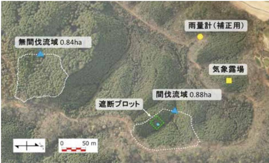
図1 常陸太田試験地内の間伐試験流域。スギ・ヒノキの人工林。間伐流域は1987年植栽、無間伐流域は1924年植栽。気象露場において降水量、遮断プロットにおいて樹冠通過雨量と樹幹流量を観測。▲は量水堰（60°三角堰）設置地点を示す。
