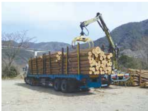
写真2 集積した素材をトラックへ積込
