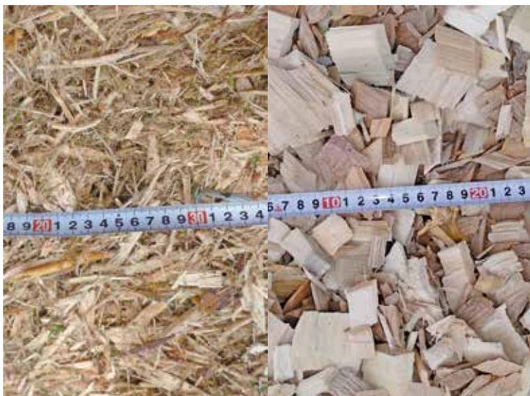
写真2 破碎チップと切削チップ
