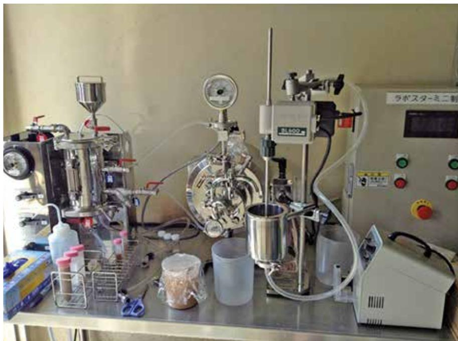
写真3 試作した小型湿式ミリング装置
