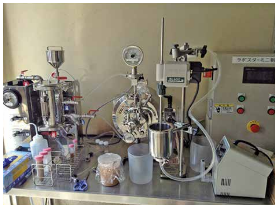
写真3 試作した小型湿式ミリング装置
