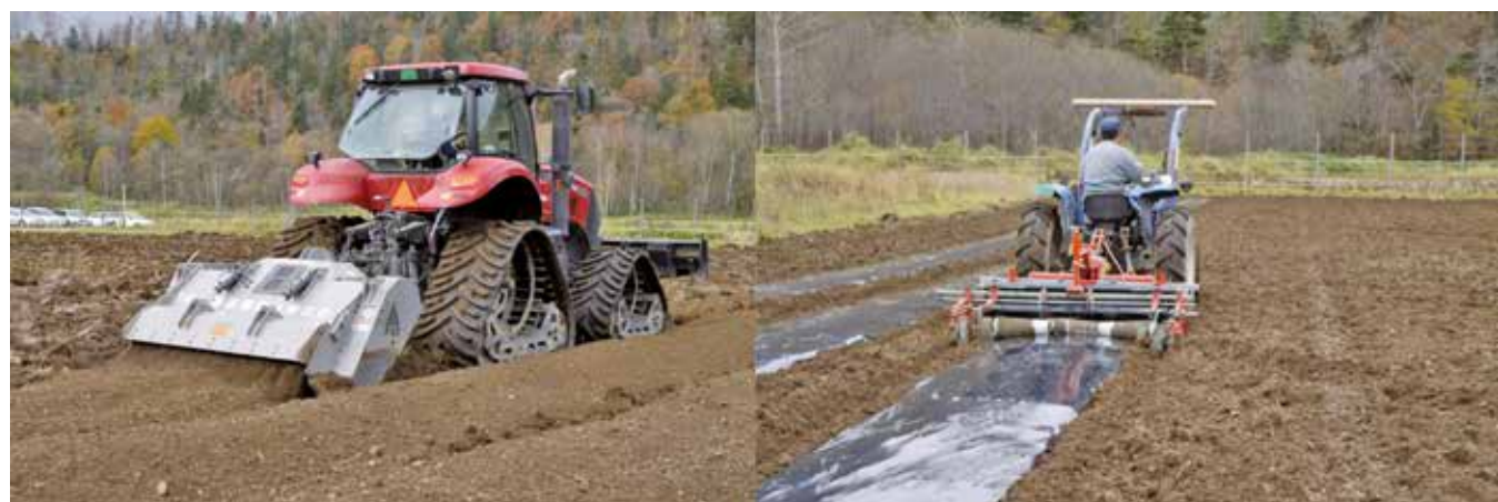
写真2 ストーンクラッシャーによる礫岩粉碎とマルチ敷設
