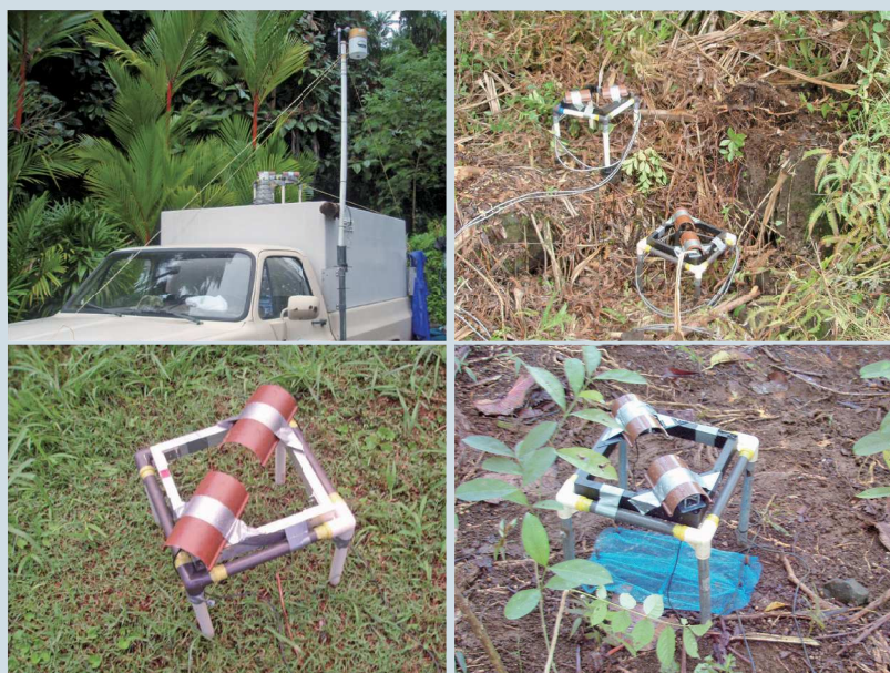
写真3 林外 (左) や林内 (右) に設置されたレーザー雨滴計 雨滴がレーザーシートを通過し遮断したときのデータから雨滴の大きさと速さを測定する
