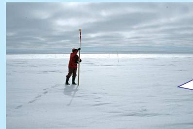
南極大陸氷床上に立てた雪尺（竹竿）の雪面上の長さを定期的に測定し、氷床の質量収支を知るためのデータを蓄積している。
