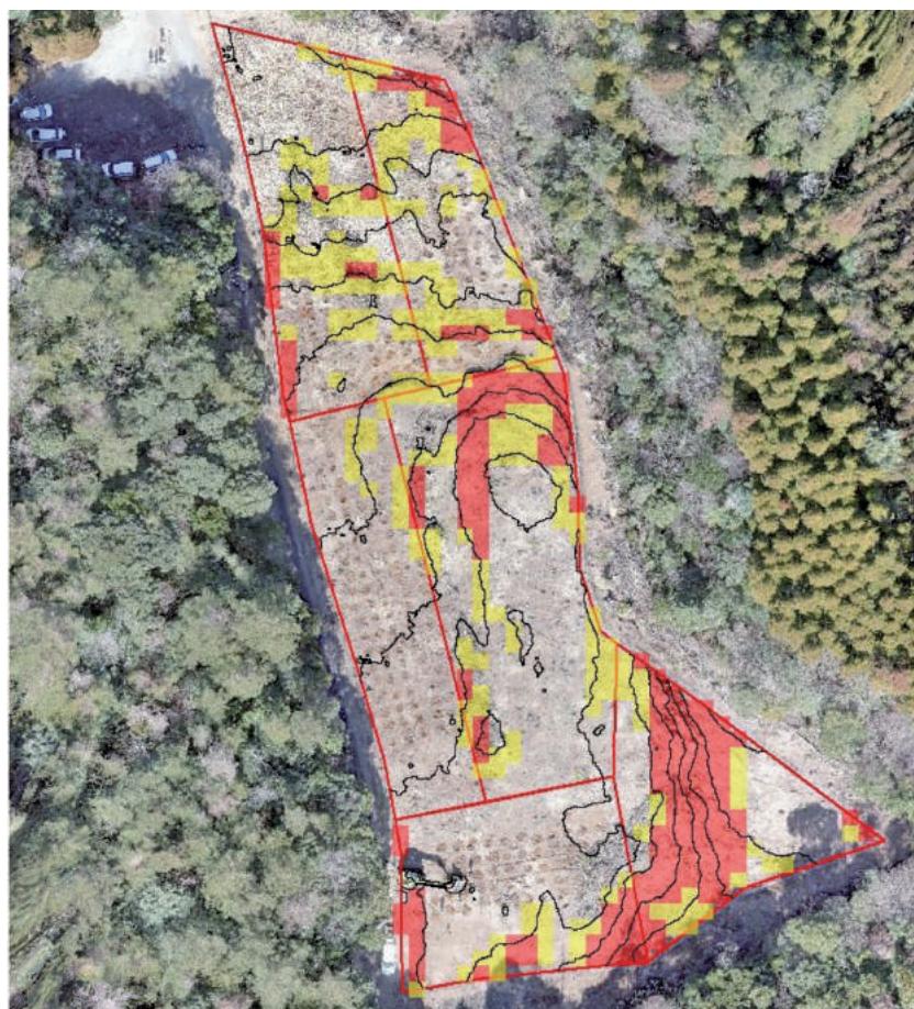
図2 ドローン空撮による皆伐跡地における地形把握と育林作業機走行危険箇所の表示（宮崎県えびの市） 赤い箇所は育林作業機の走行に危険な箇所、黄色い箇所は走行に注意が必要な箇所を表しています。
