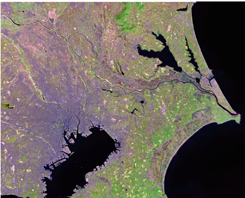
図2 ランドサット8号による広域観測(関東周辺) (Image courtesy of the U.S. Geological Survey) 地球観測衛星では、一度にこのように広い地域を観測することができます。
