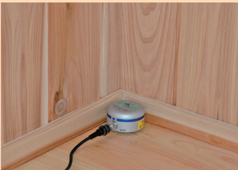
写真2 住宅の内部の床にセンサーを置いて、振動を測定している様子 住宅内で1階と2階合わせて257箇所を測定
