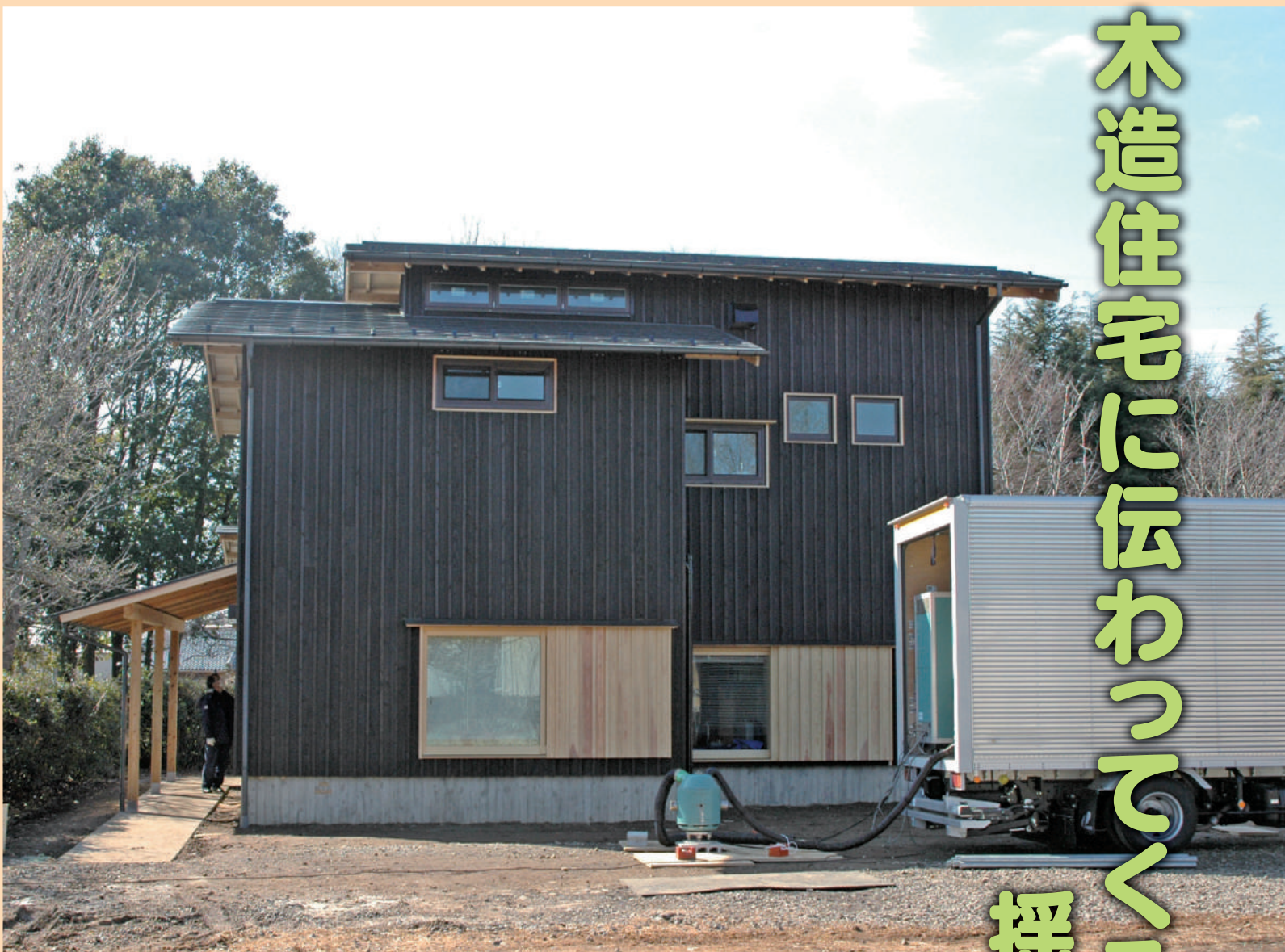
写真1 実験住宅の外で振動を発生させている様子
