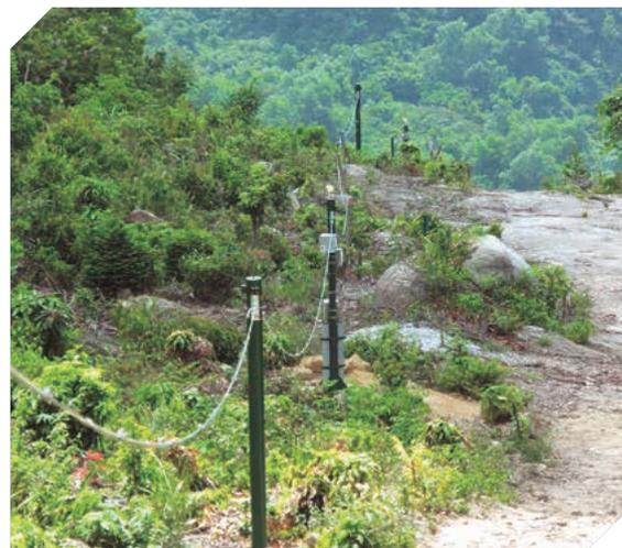
写真3 わずかな地表の変位を測定するセンサー群
