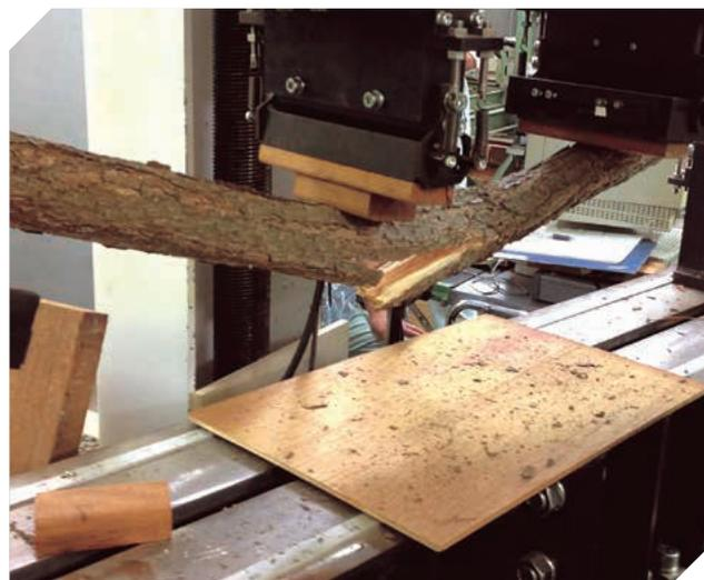
写真2 曲げ破壊試験の様子
