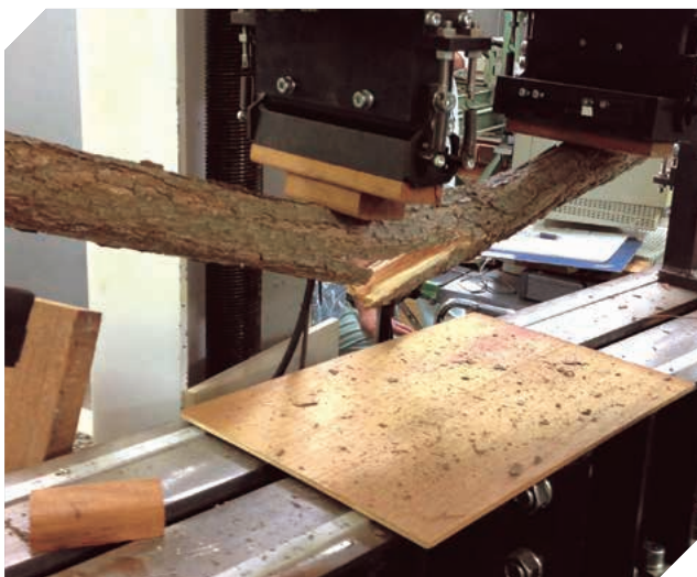
写真2 曲げ破壊試験の様子
