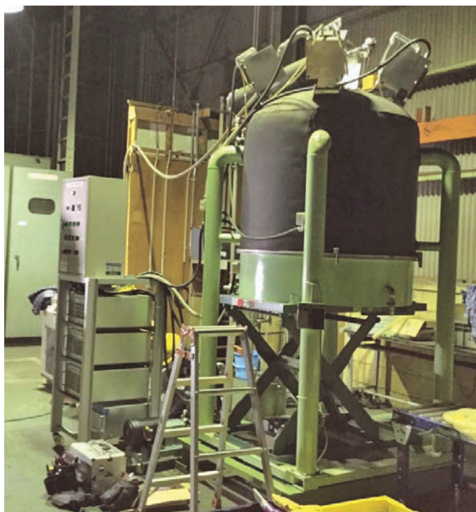
写真2 マイクロ波減圧コントロール水蒸気蒸留装置
