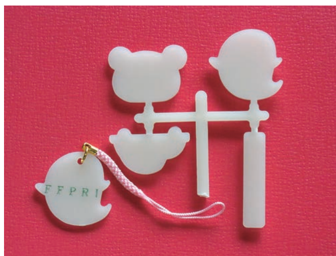
写真3 スギCNFとポリプロピレンの複合材射出成型物
