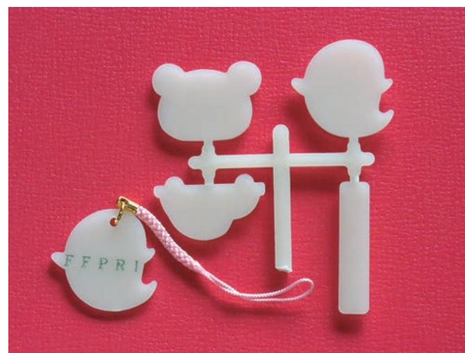
写真3 スギCNFとポリプロピレンの複合材射出成型物
