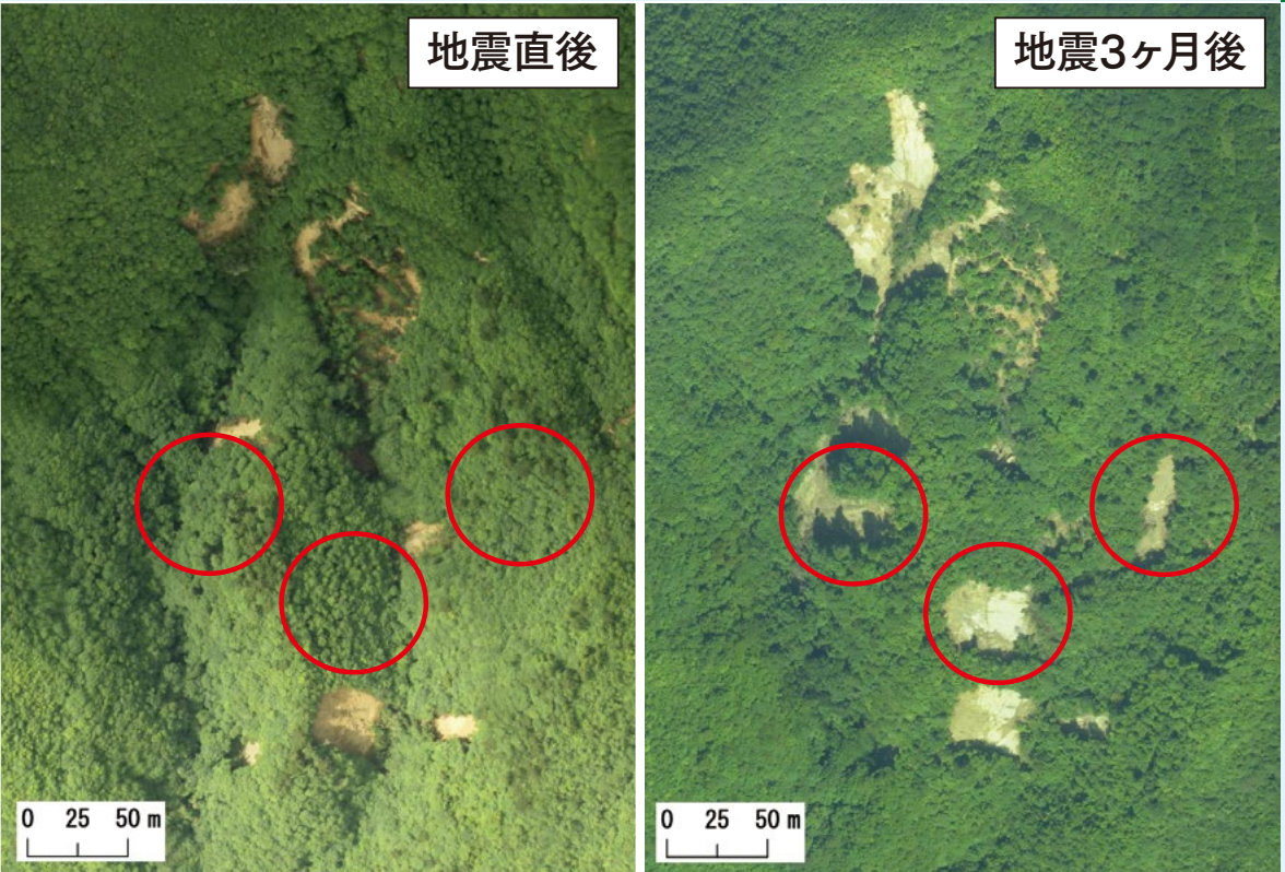
写真1 2008年岩手・宮城内陸地震直後と3ヶ月後に林野庁により撮影された空中写真 赤枠で示した斜面では、地震後の降雨により崩壊が発生していました。
