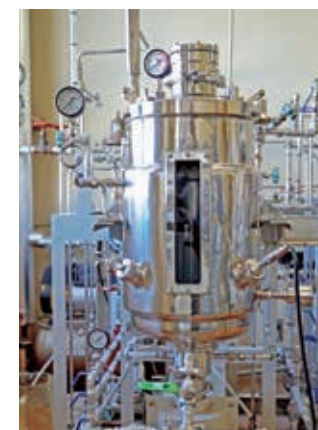
写真3 発酵タンク 1回に木材2kgを仕込む
