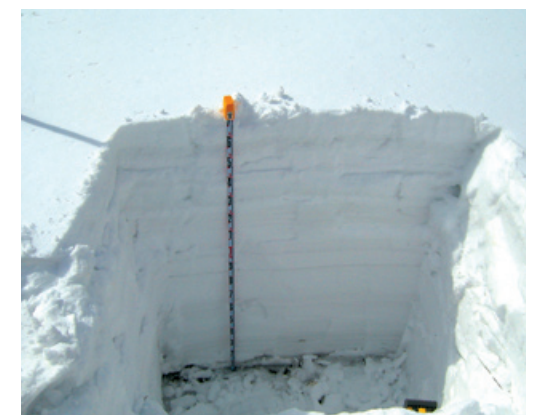
写真2 調査用の積雪断面。この時の積雪深は約1.7m。
