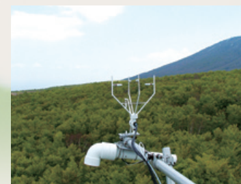
写真 ブナ林におけるCO 2 収支の観測タワー(岩手県八幡平市安比)
