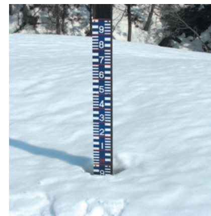
写真1 積雪深測定用の標尺。この時の積雪深は約1.9m。
