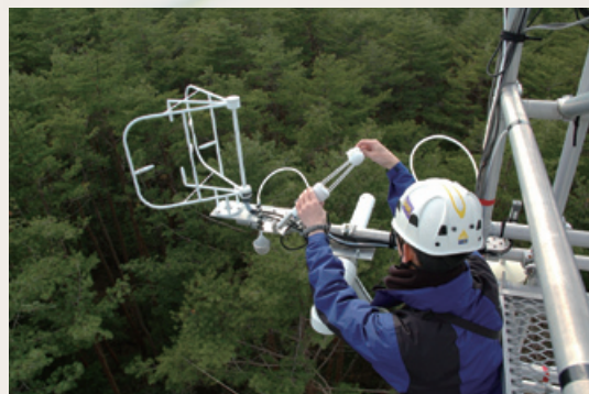
森林による二酸化炭素吸収量を連続測定する「タワーフラックス観測」のようす(山梨県富士吉田市)
