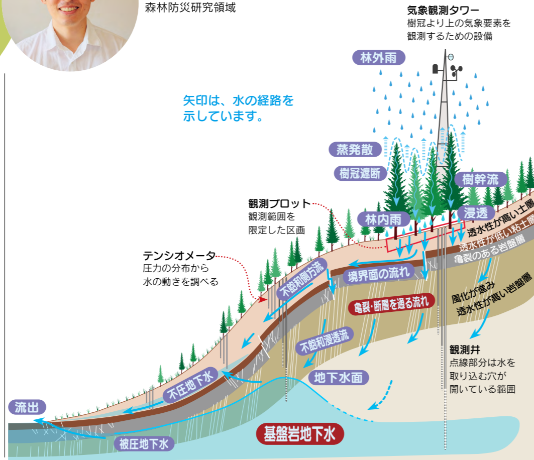
図1 森林小流域における、降った雨が流出するまでの経路とそれを観測するための機器・施設
