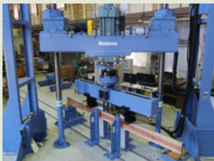
実験施設(木材強度試験機)の見学
