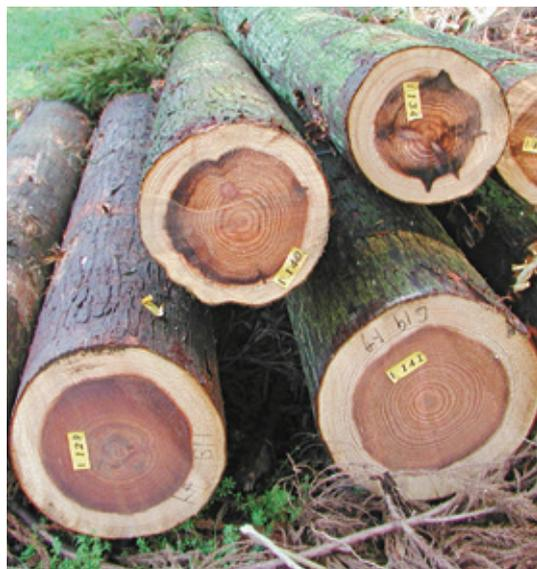
**写真1** スギの丸太の心材
