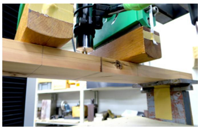
写真2 曲げ試験の様子 左の写真は、破壊の様子の一例。フィンガージョイントでの破壊(木材の右側)と節での破壊(木材の左側)が生じたことがわかる。右の写真は、試験時の様子。上部の2か所から加力して強度を測定する。フィンガージョイント部を加力点間の中央に配置して実験を行った。
