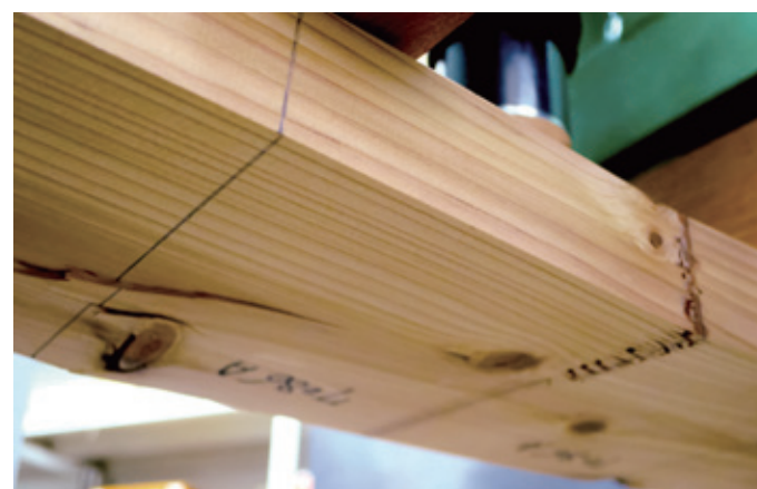
写真2 曲げ試験の様子 左の写真は、破壊の様子。フィンガージョイントでの破壊(木材の右側)と節での破壊(木材の左側)が生じたことがわかる。右の写真は、試験時の様子。上部の2か所から加力して強度を測定する。フィンガージョイント部を加力点間の中央に配置して実験を行った。
