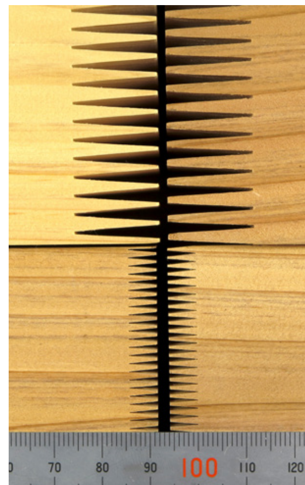
写真1 フィンガージョイント 上:長さ17mmのフィンガージョイント、 下:マイクロフィンガージョイント(フィンガーの長さ6mm)
