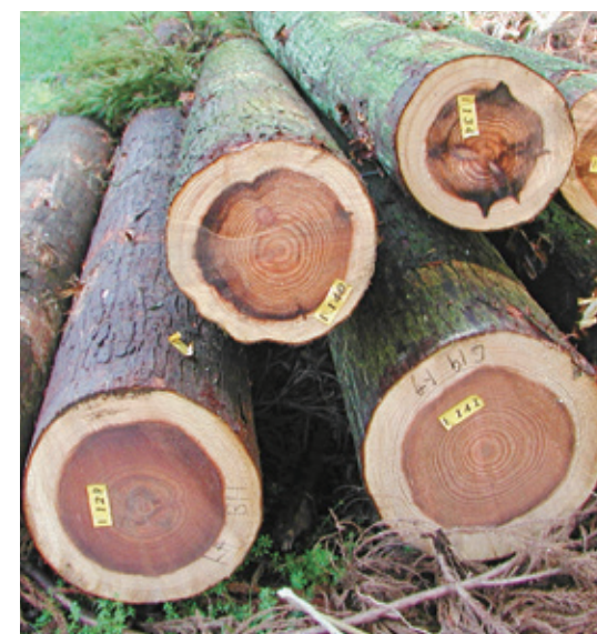
写真1 スギの丸太の心材 中央の濃い色の部分が心材で取り囲んでいる薄い色の部分が辺材。心材の色は木の種類によって様々。
