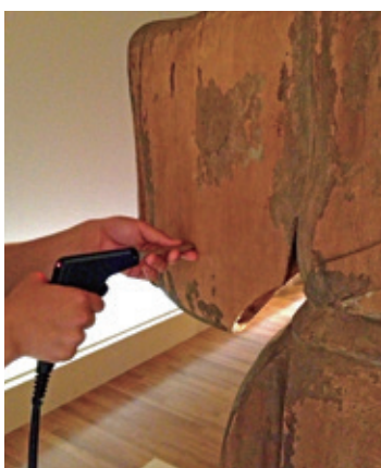
写真3 木彫像からの近赤外線の吸収データの測定
