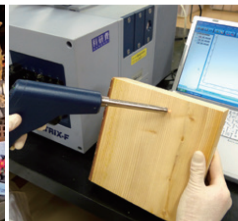
写真1 木材の標本からの近赤外線の吸収データの測定
