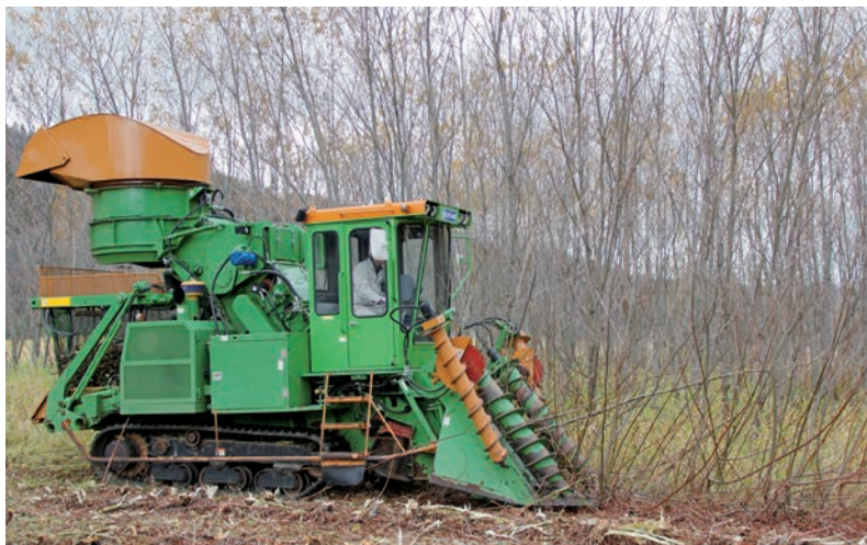
写真1 ケーンハーベスタによるヤナギの収穫風景
